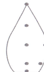
Рис. 8. Точки измерения температуры пламени
